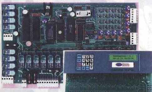
**DD24LCD** è un PLC completo e pronto all'uso realizzato con una scheda a microprocessore basata su Z84C00 con quarzo a 10 MHz. Caratteristiche:
