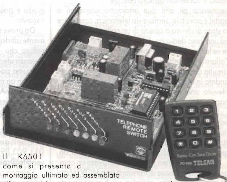
Il K6501 come si presenta a montaggio ultimato ed assemblato all'interno del suo contenitore, opzionale, e con il telecomando, anch'esso opzionale.
